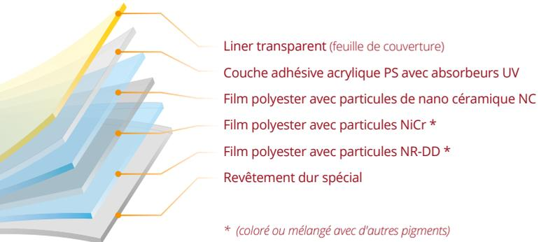
La combinaison de nanoparticules de céramique, de microcomposants métallisés et de pigments absorbant les UV dans les différentes couches permet d'obtenir un film de protection solaire qui répond exactement aux attentes :
